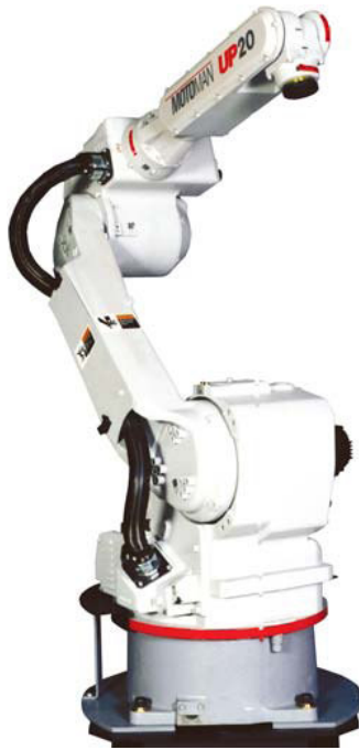
FIG. 24 - Robô industrial utilizado em soldagem robotizada Fonte: SENAI. RS. Centro Tecnológico de Mecatrônica SENAI
