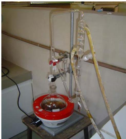
FIGURA 9 – Destilação de óleos essenciais para determinação quantitativa
