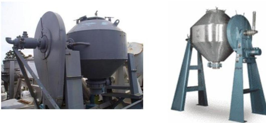
Figura 10 - Secadores rotatórios cônicos a vácuo
