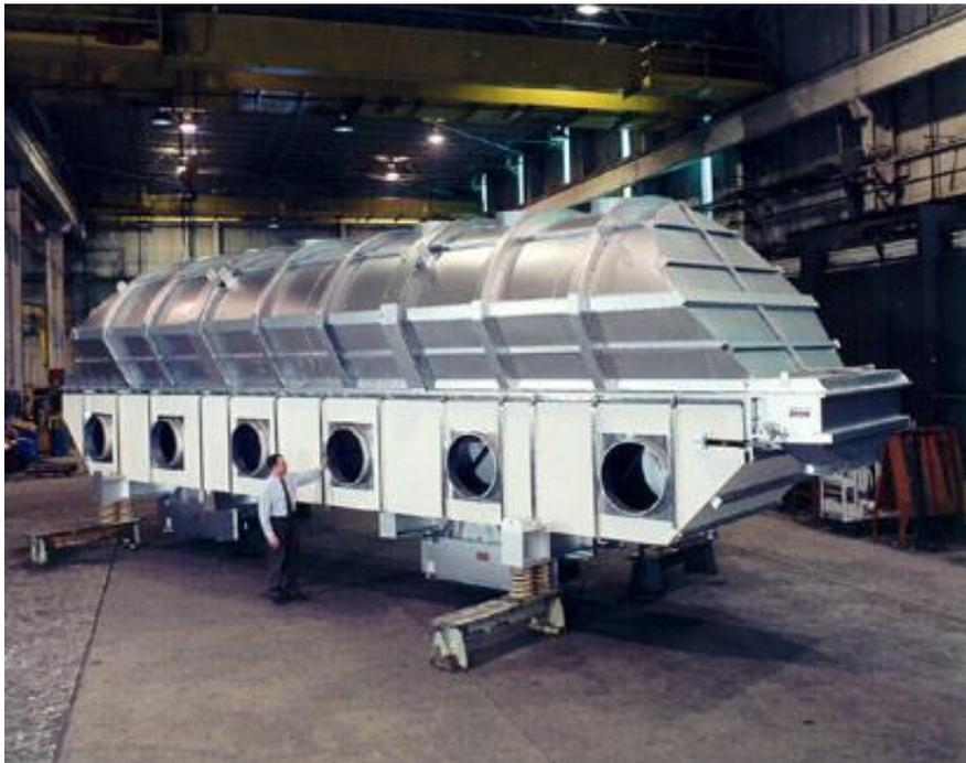
Figura 14 – Secador de leito fluidizado
