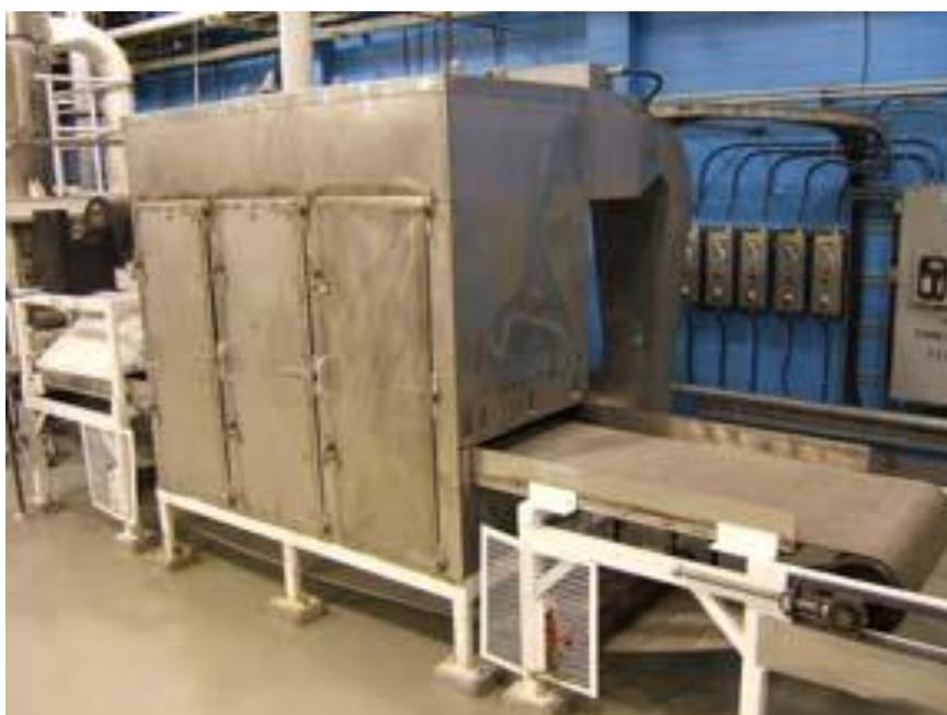
Figura 6 – Secador transportador
