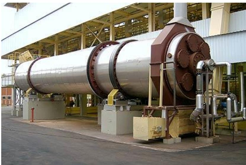
Figura 8 – Secador rotatório
