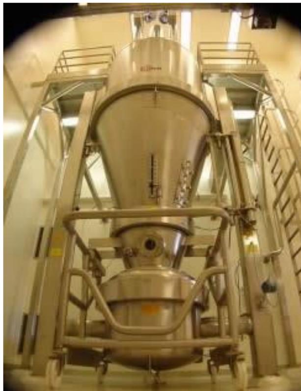
Figura 17 – Secador pulverizador
