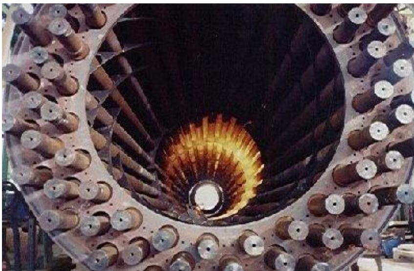
Figura 9 - Vista interna de um secador rotatório, realçando a disposição dos tubos de vapor internos
