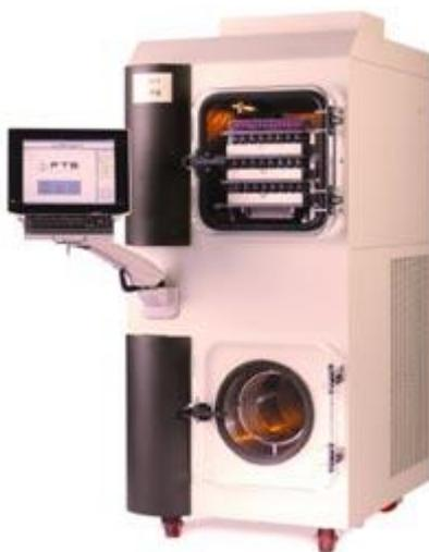
Figura 4 - Secador-congelador a bandejas operando a vácuo
