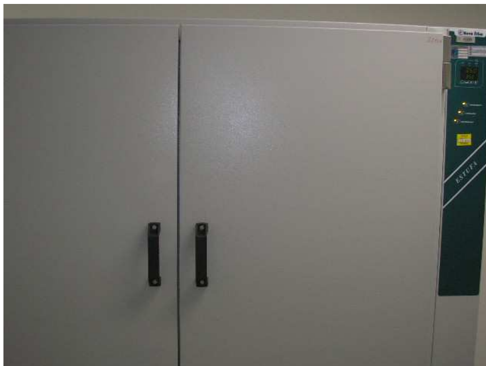
Figura 9 - Estufa de incubação das placas amostradas do ar, temperatura de incubação 25°C, por um período de 7 dias. Fonte: HIGASKINO; FIGEL, 2007.
