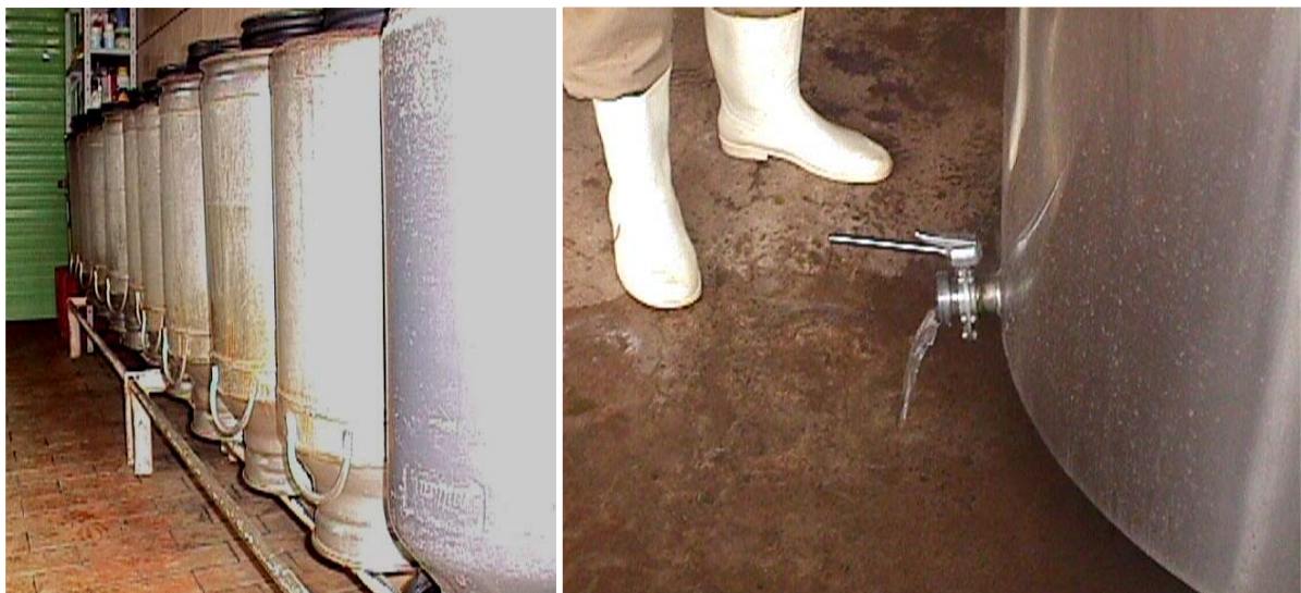
FIG 23. Secagem de latões e tanque de resfriamento evitando acúmulo de água residual. Acervo pessoal/LIPOA/UEL.
