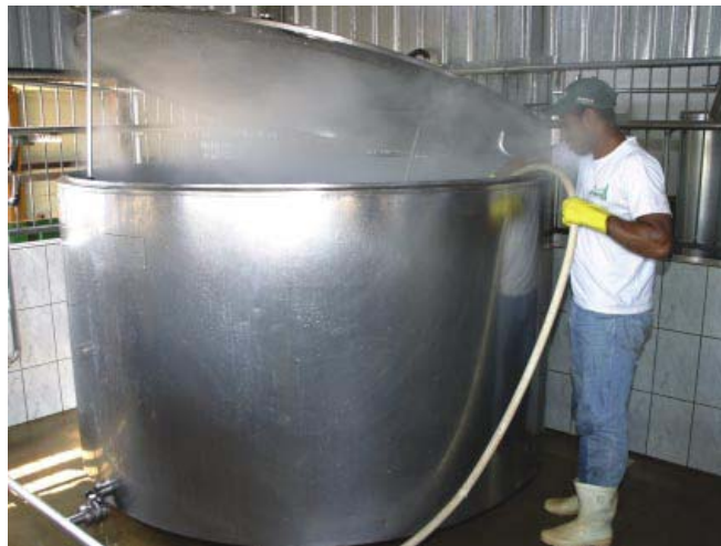
Fig.22. Higienização de tanques de resfriamento com água aquecida e detergentes adequados. Disponível em: SENAR-Serviço Nacional de Aprendizagem Rural, 2005.
