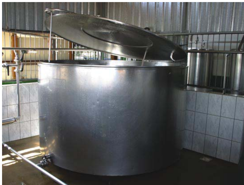
FIG. 24. Tanques de resfriamento. SENAR-Serviço Nacional de Aprendizagem Rural,2005.
