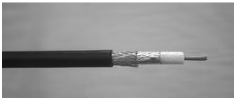
FIG. 12 – Camadas de um cabo coaxial
