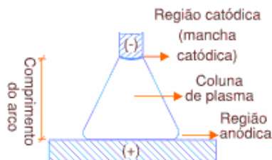
Figura 4 - Soldagem a arco elétrico
