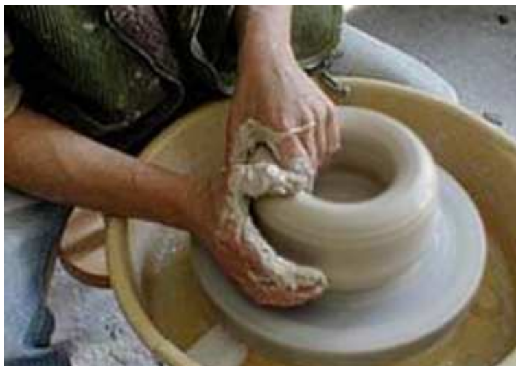
Figura 4 - Modelagem da argila na roda de oleiro Fonte: VIANA E TAL
