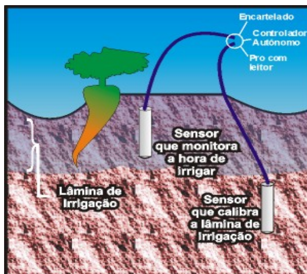
Figura 1: Instalação dos sensores
