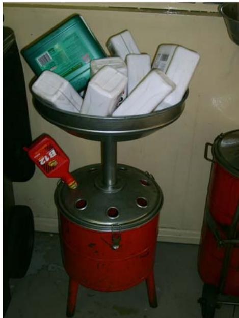
Figura 7 - Prática de escoamento de óleo lubrificante automotivo residual das embalagens.
