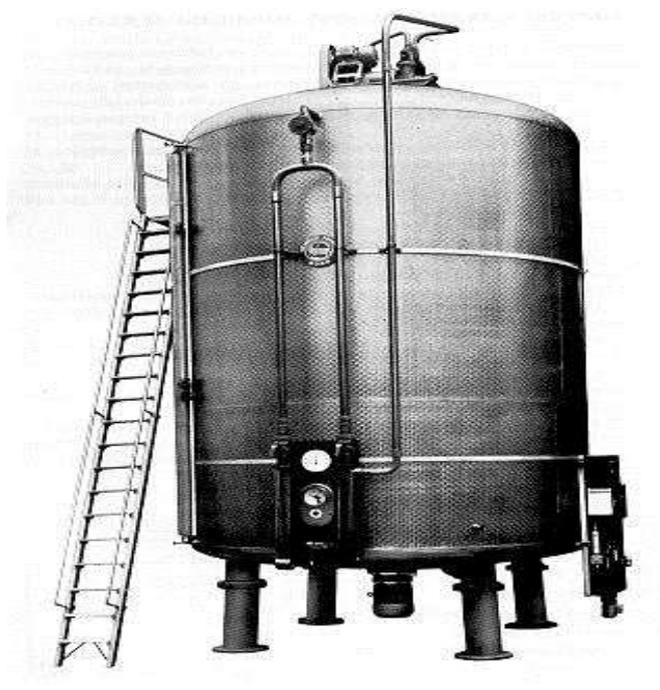
Figura 5 – Vista geral de um acetificador em aço inoxidável
