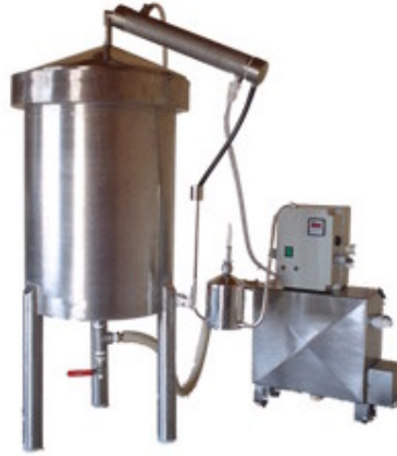
Figura 4: Destilador piloto para produção de óleos essenciais Fonte: LINAX.
