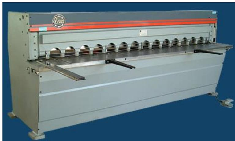
Figura 11 - Guilhotina hidráulica corte vertical
