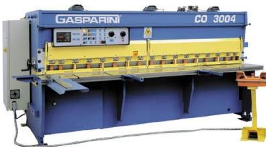
Figura 13 - Guillhotina hidráulica
