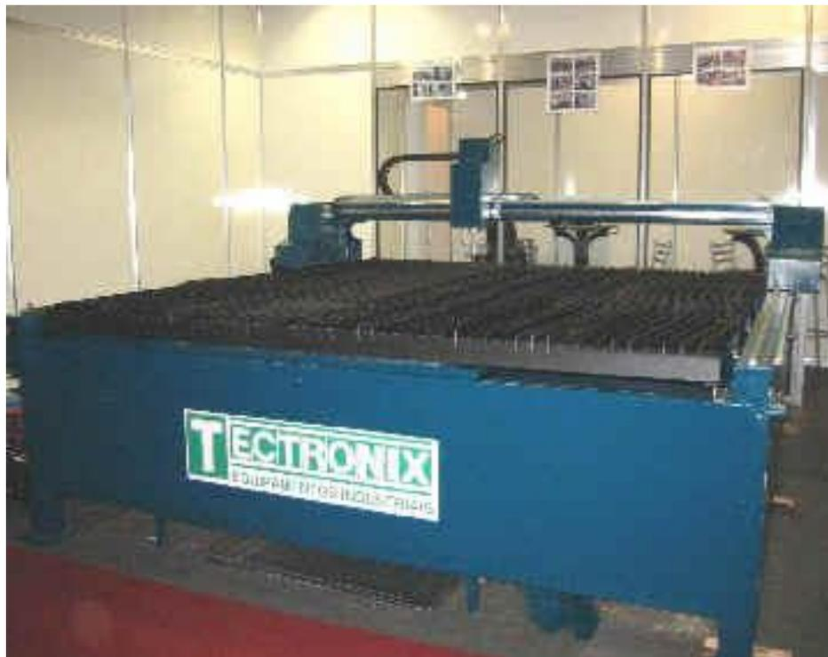
Figura 18 - Corte por plasma CNC
