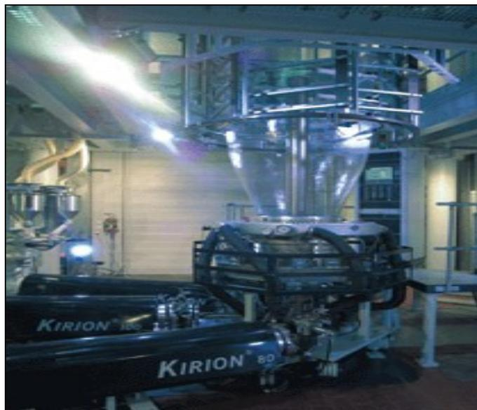
Figura 1 – Extrusão de filme tubular
