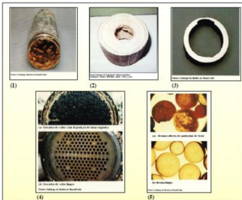
Figura 4 - Problemas associados à qualidade da água para uso industrial – (1) Corrosão alveolar em tubulação do sistema de refrigeração; (2) Incrustação em tubulação de sistema de refrigeração; (3) Corrosão devido à presença de gás carbônico em caldeira; (4) Depósito de lama orgânica em trocador de calor e (5) Depósito de partículas de ferro em resinas de troca iônica.
