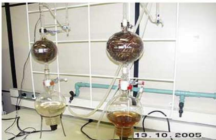
Figura 8 – Unidade laboratorial de extração por arraste a vapor
