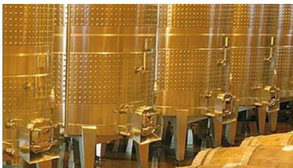
Figura 1 – Tanques de fermentação de pequeno volume em aço inox
