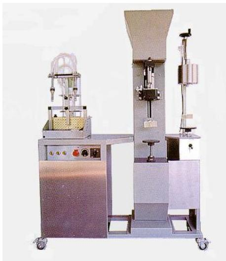
Figura 5 – Máquina para engarrafamento do vinho, colocação da rolha e da cápsula na garrafa.
