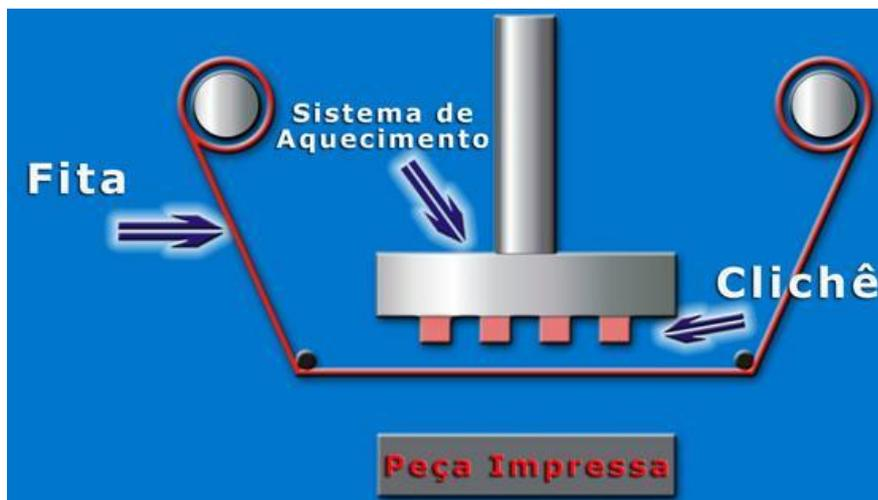
Figura 19 – Representação do sistema de impressão *hot stamping*
