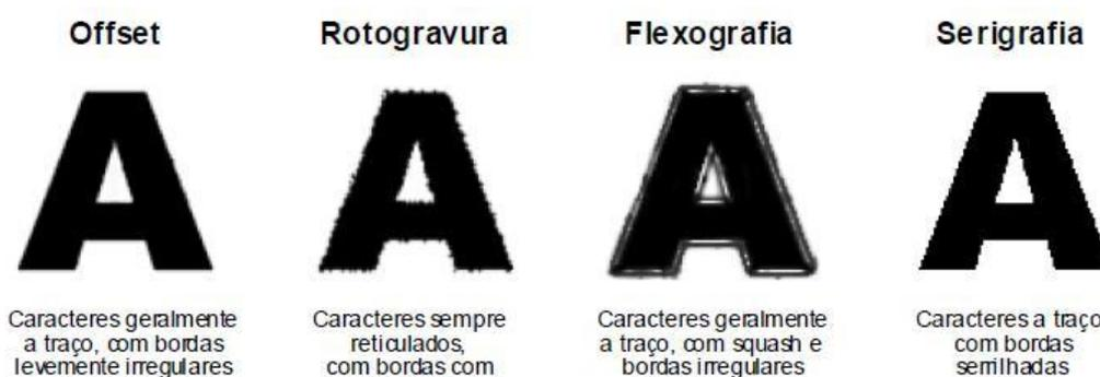
Figura 2 – Comparação dos caracteres impressos em diferentes sistemas de impressão
