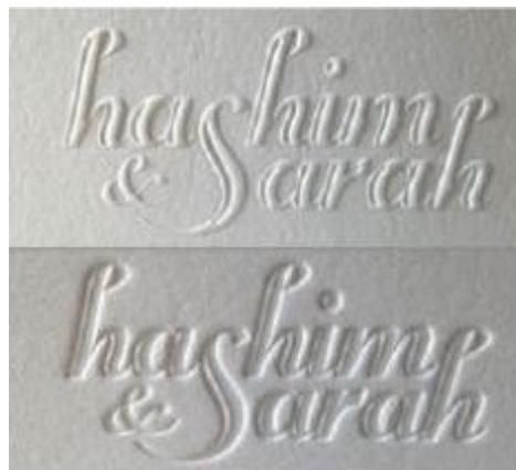
Figura 21 – Comparação entre relevo seco e *Letterpress*
