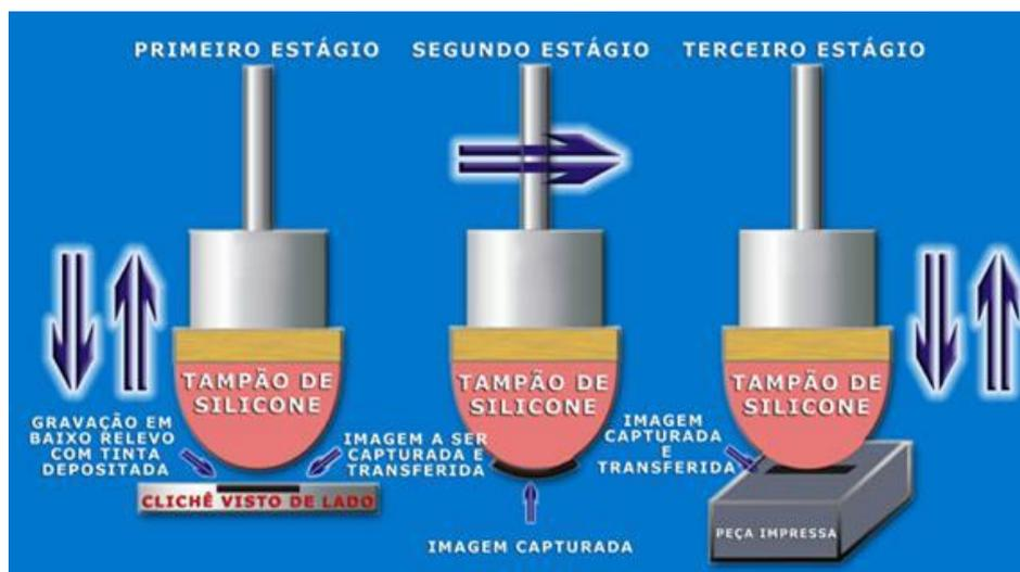
Figura 6 – Representação do sistema de impressão tampográfico
