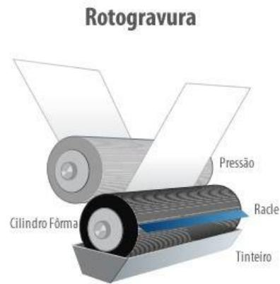
Figura 5 - Representação do sistema de impressão rotográfico
