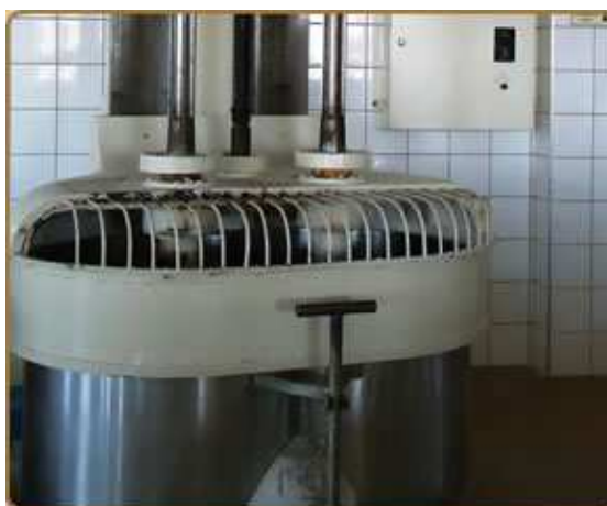
Figura 6 - Equipamento utilizado para fazer o batimento da massa Fonte: (BISCOITOS ZEZÉ, [200-?])
