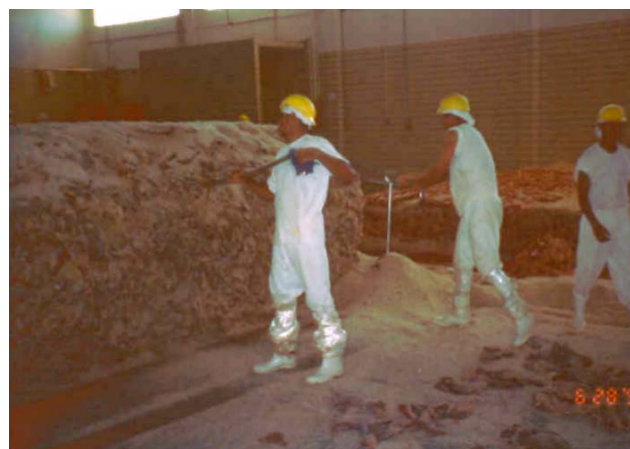
Figura 3 e 4- Salga e ressalga das mantas, inversão da posição das peças. Fonte: Elmo Rampine - Curso de pós-graduação Equalis
