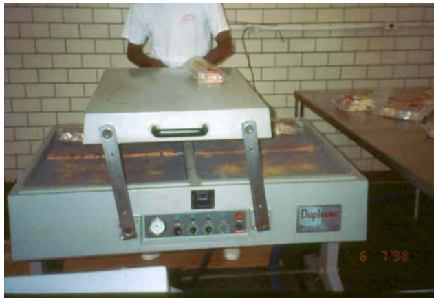
Figura 10 – Máquina de embalagem a vácuo. Fonte: Elmo Rampine - Curso de pós-graduação Equalis
