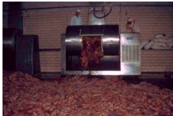
Figura 2: Cilindros giratórios utilizados para a salmoragem das mantas. Fonte: Elmo Rampine - Curso de pós-graduação Equalis
