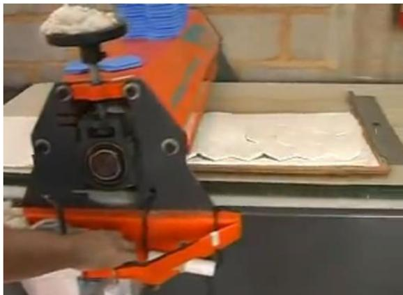
Figura 1 – Máquina de corte para o formato dos gomos
