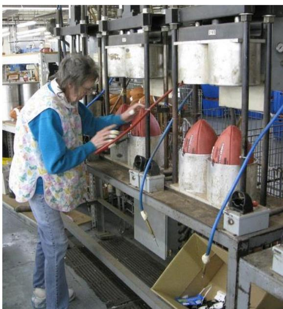
Figura 22 – Moldagem da bola
