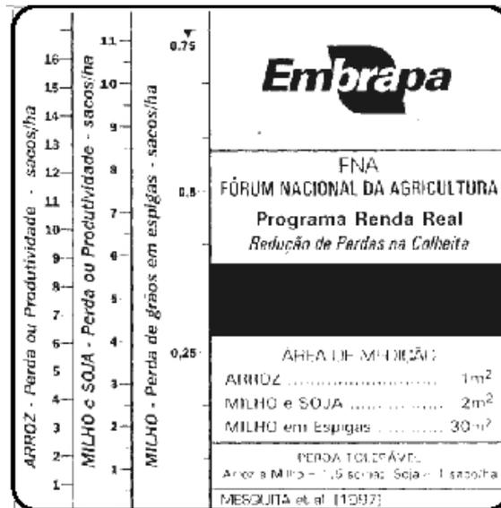
Figura 18 – Tabela impressa no medidor com os valores de perdas e de produtividade.
