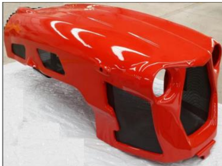
Figura 1 - Capô de trator em compósito de PRFV por processo de spray-up . Fonte: (MARIN, 2016, p. 11).
